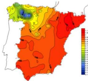
Figura 6. Gráfica de requisitos frente a huecos de tensión de las instalaciones eólicas y ejemplo de extensión del hueco en el sistema eléctrico peninsular provocado por un cortocircuito.
